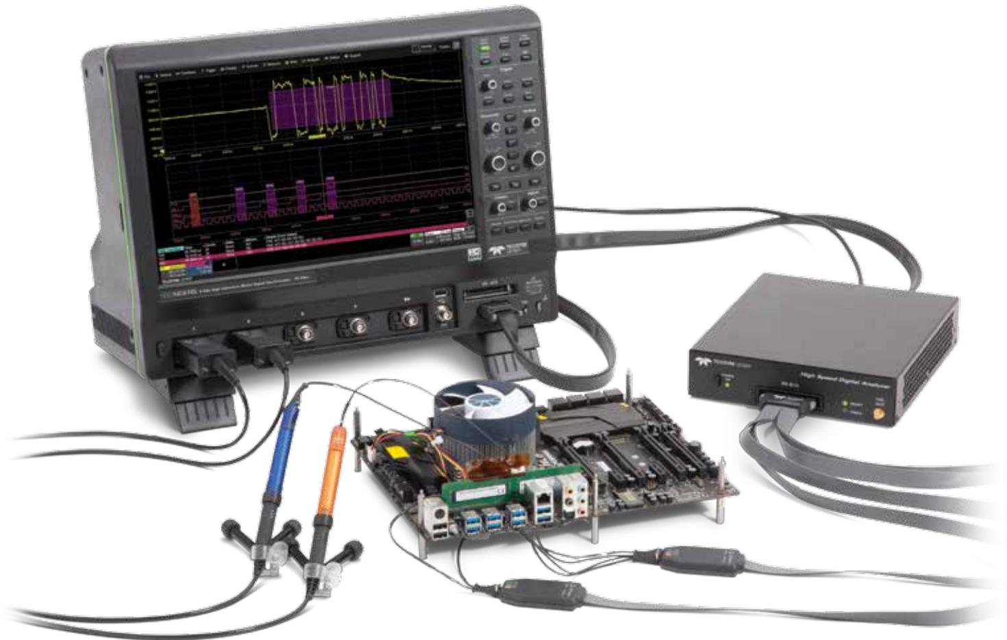
**Высокоскоростной анализатор параллельных шин HDA125 расширяет возможность анализа смешанных сигналов HDO9000R в случаях работы с более высокоскоростными цифровыми сигналами. Частота выборки до 12,5 Гвыб/с, 18 цифровых каналов и инновационная система гибкого подключения пробников (Quick Link) упрощают проверку и анализ сложных интерфейсов, таких как DDR память.**
