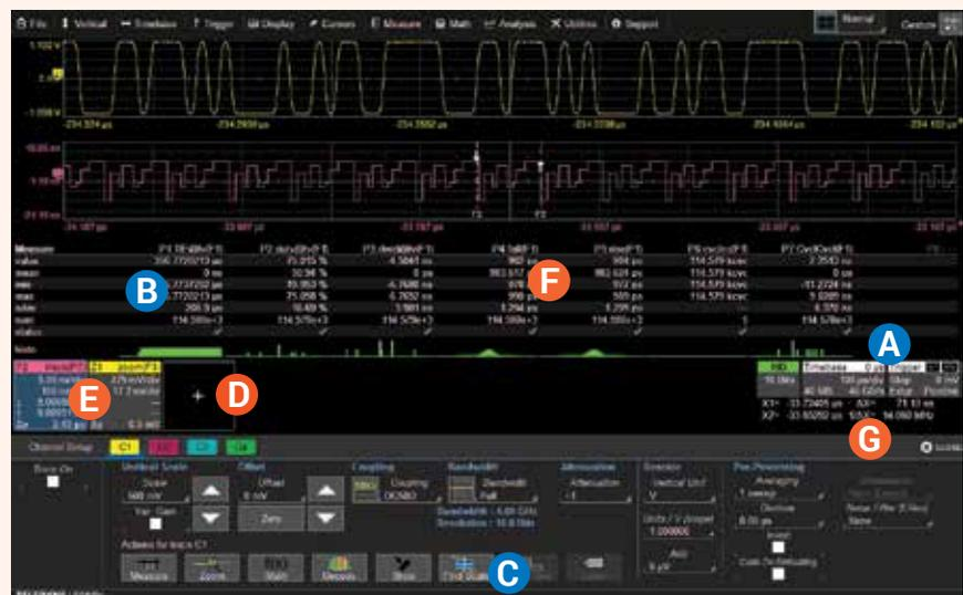
**A** Дескрипторы канала, развертки и синхронизации обеспечивают быстрый доступ к настройкам без входа в меню.
