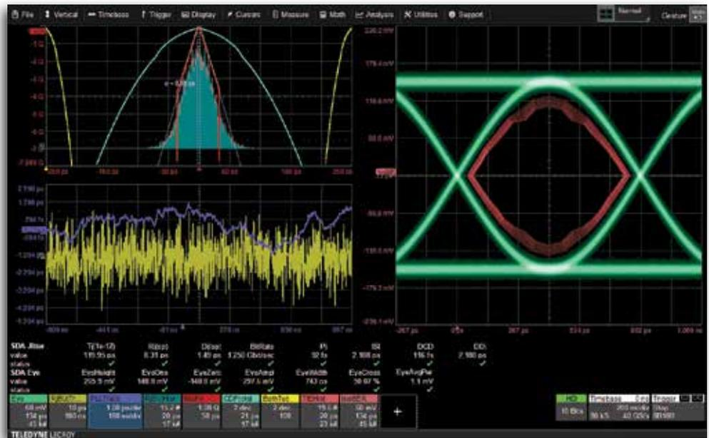
ствии, HDO9000R быстро локализует проблему. Прогрессивный метод разложения джиттера и инструменты анализа дают больше информации о корне проблем. Инструменты анализа: Tj (суммарный), DDj (джиттер данных), RjBUj
