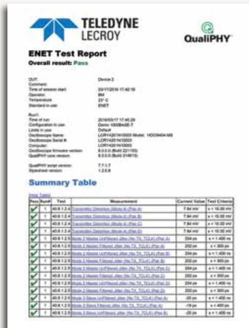
Отчеты испытаний содержат все параметры теста и их значения, специфические пределы и скриншоты экрана. Отчеты теста на соответствие могут создаваться в виде файлов HTML, PDF или XML.
