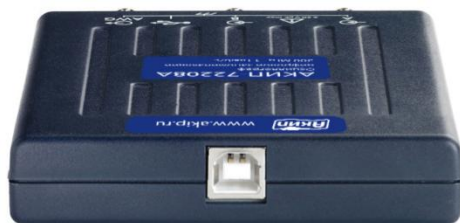
Задняя панель: интерфейс USB2.0
