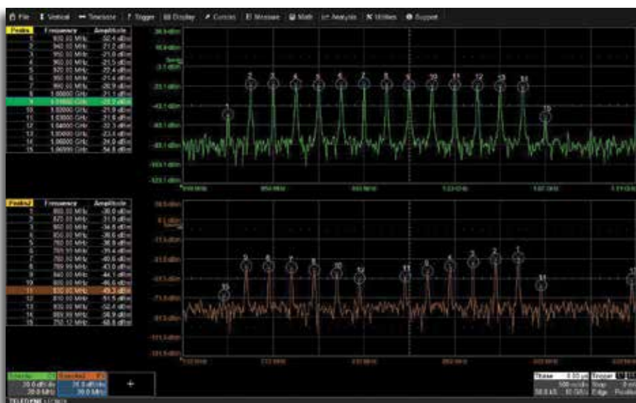
Используйте 2 независимых входных параметра (Пик. Значения/ Пик. значения 2) и различные частоты для расширенного спектрального анализа.
