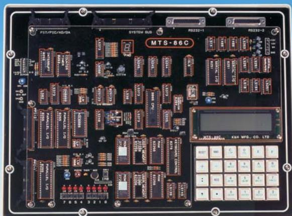
Система MTS-86C помогает студентам изучить архитектуру и процесс программирования компьютера 8086. Система состоит из пяти основных компонентов: (1) ЦПУ 8086 (2) системной и пользовательской памяти (3) комплекта популярных стандартных микросхем (4) устройств ввода-вывода и (5) внешнего интерфейса.
