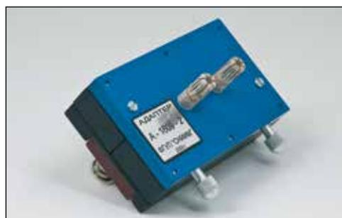
Адаптеры A-1509-1 и A-1609-2 предназначены для исключения влияния паразитной ёмкости и индуктивности при высокочастотных измерениях параметров мер электрических величин. Адаптеры используются для подключения образцовых мер электрических величин к измерителям и анализаторам электрических цепей с 4 парной системой подключения при их калибровке и поверке. Рекомендуется использовать с прецизионными измерителями. Рабочий диапазон частот адаптеров до 30 МГц.
