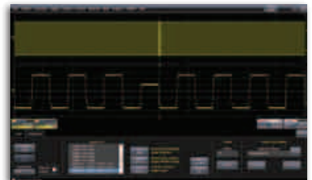
Для примера, при поиске аномалий на сигнале 200 МГц с периодом повторения 1 событие на 1 Гвыб. отсчетов (т.е 1 раз в 5 секунд) TriggerScan™ находит аномалию за 4 минуты, в то время как осциллограф с быстрым обновлением экрана (400,000 осцил./с) будет игнорировать 99,8 % полезного сигнала и для обнаружения такой аномалии может потребоваться до 42 минут.
