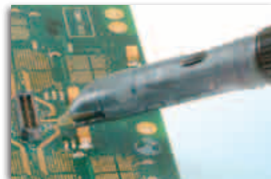
Пробники серии WaveLink - это активные дифференциальные пробники с широкой полосой пропускания. Эти пробники могут использоваться для измерений целостности сигнала высокоскоростных цифровых систем.
