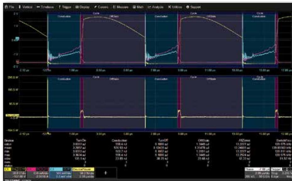
подробную картину одного цикла преобразования (периода) или отображает усредненное значение потерь мощности устройства. Помимо расширенных возможностей измерения потерь мощности, пакет «Анализ мощности» предоставляет ресурсы для анализа модулированных сигналов и ШИМ-устройств. Это обеспечивает глубокое проникновение в детали сигнала для понимания функционирования
