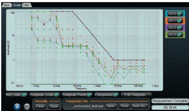
Окно измерения при тестировании на устойчивость к джиттеру (jitter tolerance test) в ПО N4980A
