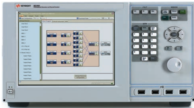
Реализация потокового воспроизведения захваченного сигнала с помощью PXB
