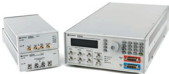
Тестер N4960A с выносными головками генератора кодовых последовательностей N4951B и детектора ошибок N4952A
