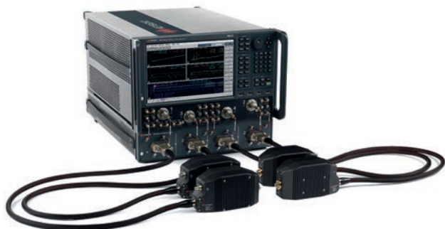
Анализаторы цепей миллиметрового диапазона с диапазоном частот до 120 ГГц на базе анализатора цепей серии PNA-X N5290/91A доступны только в 4-портовых конфигурациях. 2-портовые решения доступны при использовании 2-портового анализатора цепей серии PNA. Широкополосные системы N5290/91A обеспечивают возможности измерений, необходимые для полного определения параметров пассивных и активных устройств, а также преобразователей частоты. Эти системы являются компактной заменой предшествующих систем N5251A, обеспечивая улучшенные характеристики и более широкий диапазон частот.
