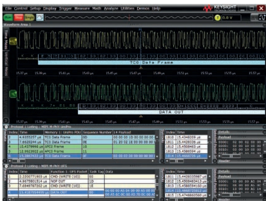
Пример декодирования двух протоколов одновременно.
