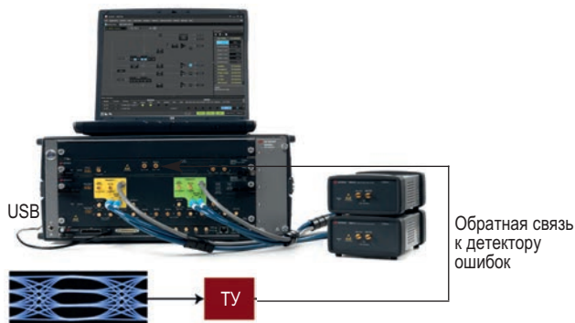
Сигналы PAM-4 и NRZ; 1- или 2-канальный генератор кодовых последовательностей с выносными головками, коррекция предскажений и внесение джиттера
