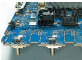
Малопомнящие входные каскады и корректирующие фильтры обеспечивают равномерную частотную характеристику
