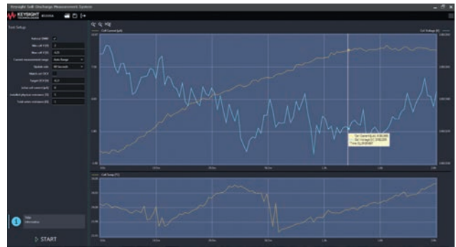
Результат теста на BT2191A для "хорошей" батареи. 1-канальная система измерила стабильный ток саморазряда в 9,08 мкА за ~1,5 часа.
