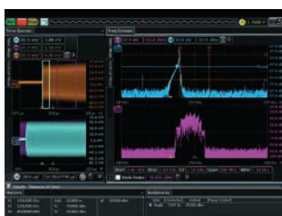
Испытания на соответствие маске, программы и широкое разнообразие функций, таких как БПФ, обеспечивают глубокий анализ сигналов
