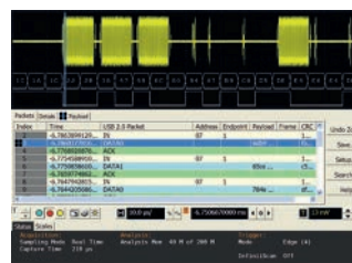
Запуск по сигналам и декодирование данных последовательной шины USB
