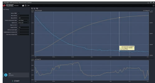
Результат теста на BT2191A для "плохой" батареи. 1-канальная система измерила стабильный ток саморазряда в 150 мкА за ~2 часа.
