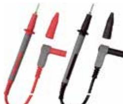
**Щуп:** 2 мм твердосплавный с резьбой. Коннектор: 4 мм изолированный типа «банан» папа (с изгибом 90 градусов), с двойной изоляцией, подпружиненный. Длина провода 1,1 м.
