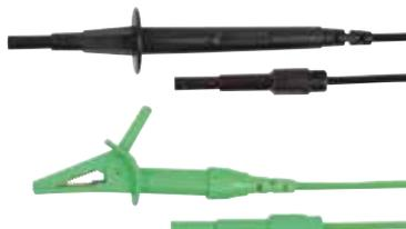
**Щуп:** латуны, подпруж. диам. 4 мм, сдвигная изоляц. шторка; **зажим:** "крокодил" охват 35 мм; **провод:** мн.-жил. PVC изол., 3,5 мм<sup>2</sup>, дл. 1 м; **коннекторы:** "банан", с изоляц. сдвигной шторкой, подпруж. "папа"; **цвета:** зелёный, чёрный
