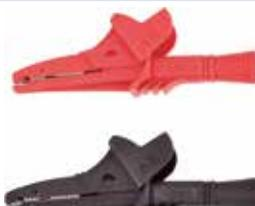
**Зажим:** 98 x 41 мм. Рабочая часть: тип «крокодил»; макс. раскрыт 20 мм. Коннектор: 4 мм, тип «мама», в изоляции. **Цвета зажимов:** красный, чёрный.
