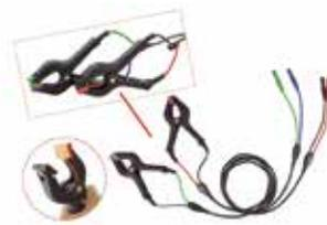
Комплект измер. проводов для 4-х проводного измерения сопротивления: 4 «банана» на 2 мощных клещевых зажимах типа «крокодил»/ Kelvin). Длина кабеля 1 м, материал ПВХ, диаметр коннекторов 4 мм.
