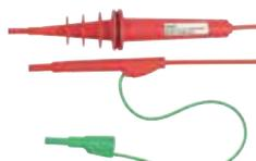
**Щуп:** подпруж. «банан» «папа», изол. сдвигная оболочка; **провод:** силиконовая изоляция 2,7 м; **коннектор:** попружин. «банан» в изолир. оболочке с дополнительным отводом для гнезда «Guard». **Вход:** max AC 1000 В, **выход:** max DC 10 кВ, 3 Вт. Только для использования совместно с изм. сопротивления изоляции
