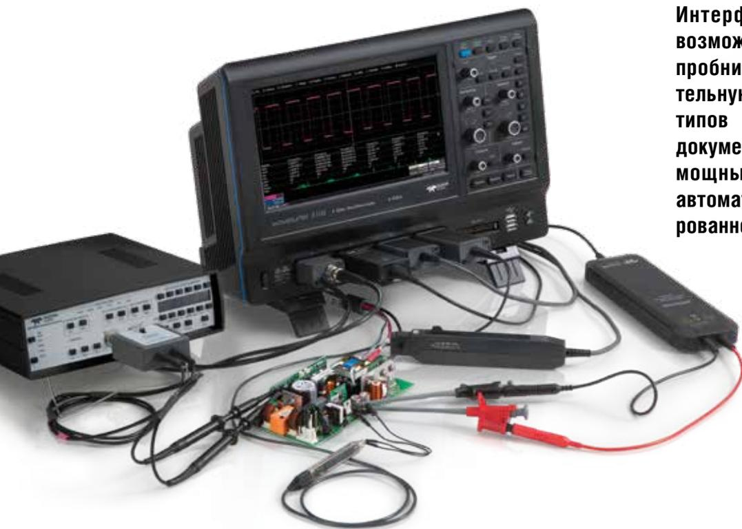
Интерфейс входных каналов с возможностью подключения активных пробников предоставляет исключительную гибкость для захвата всех типов сигналов. Отладка, анализ и документирование проблем с помощью мощных средства математики и автоматических измерений, сегментированной памяти и LabNotebook.
