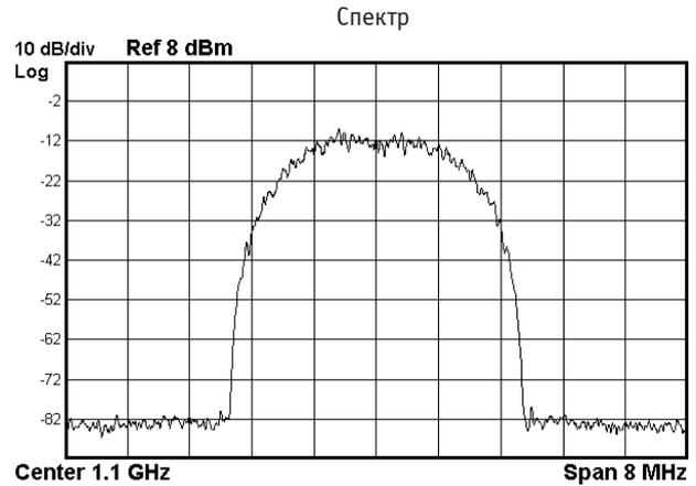
Диаграмма созвездия и спектр модулированного сигнала на частоте 1.1 ГГц 8PSK; скорость передачи данных = 16 Мбит/с; фильтр Найквиста;  $\beta = 0.9$
