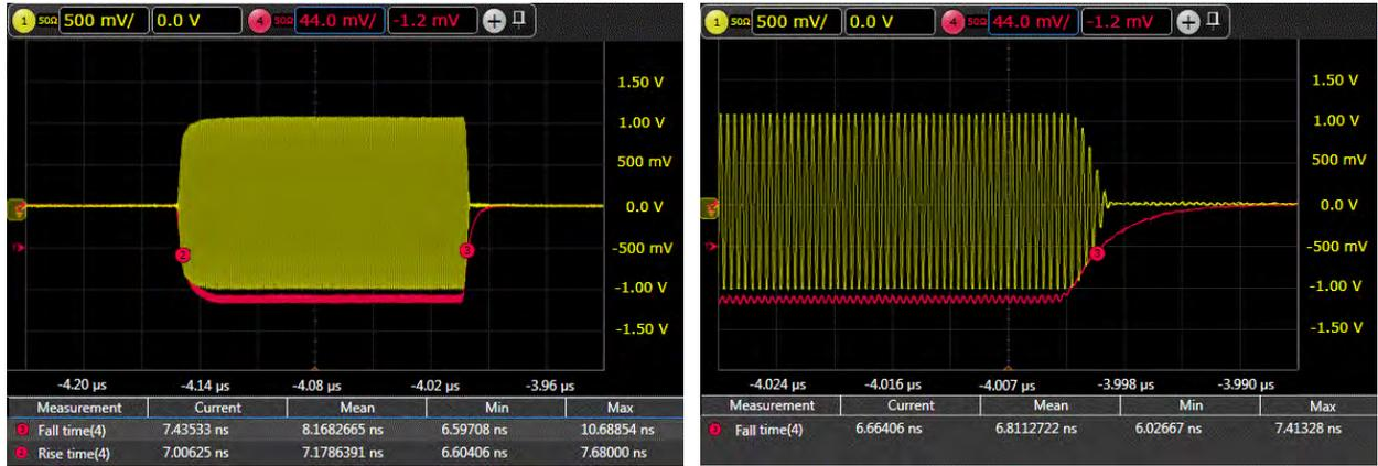
Импульсно-модулированный сигнал и соответствующий сигнал на выходе детектора. Время спада и нарастания не превышают 7.5 нс
