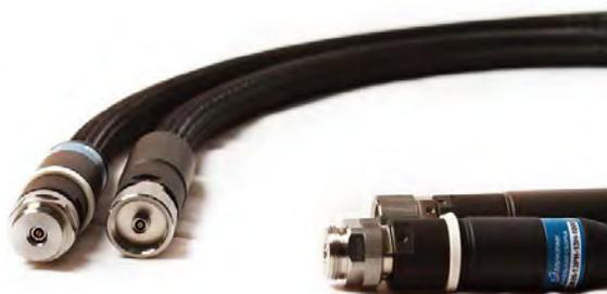
**Для повышения фазовой стабильности кабельные СВЧ сборки изготовлены со специальной защитой и соединителями усиленного типа NMD.** Защита ограничивает минимальный радиус сгибания кабеля, защищает кабель от сдавливания, продольных нагрузок и поперечного скручивания, что повышает ресурс кабеля до нескольких сотен тысяч сгибаний со стабильной фазовой характеристикой.
