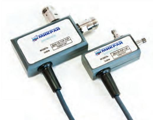
Датчики КСВ серии ДК1, ДК4 используются в анализаторах P2M для выделения электромагнитной волны, отраженной от порта исследуемого устройства при измерении модуля коэффициента отражения и КСВН.
