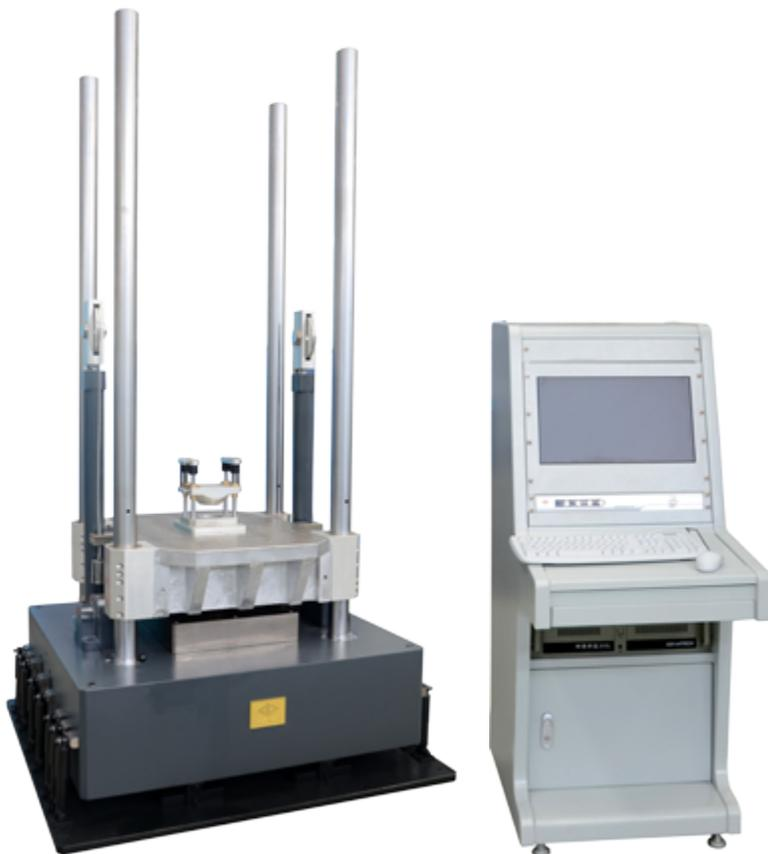
Гидравлические ударные стенды Dongling серии SY-10 идеально подходят для имитации ударного воздействия на различные образцы и изделия, для проверки их стойкости. Предназначены для оценки уровня прочности изделий и надежности их функциональности.
