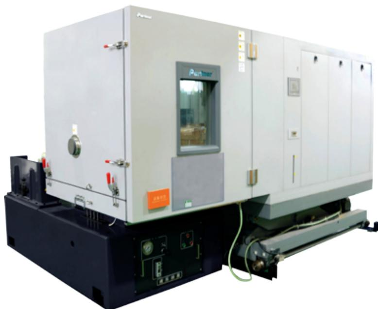
Совмещенные с вибростендом климатические камеры разработаны для моделирования различных условий, в которых будет находиться и эксплуатироваться изделие, например повышенные и пониженные температуры, повышенная влажность, пониженное давление.
