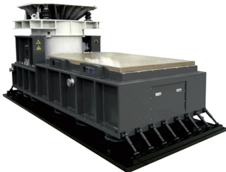
Горизонтальные скользящие столы позволяют повысить допустимую нагрузку и проводить испытания крупногабаритных и тяжелых образцов на воздействие горизонтальной (поперечной) вибрации.
