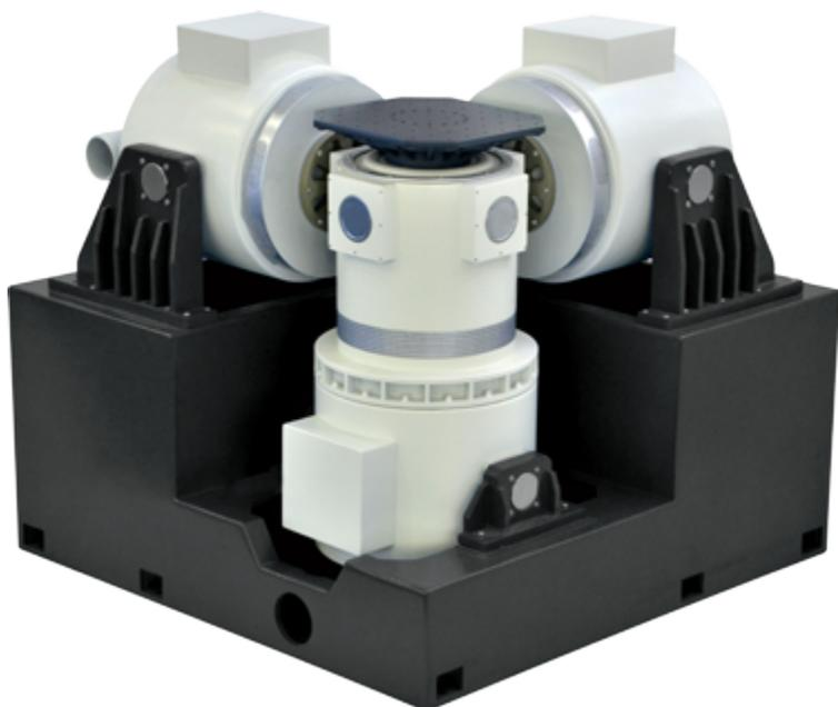
Трехосевые виброиспытательные системы с воздушным/водяным охлаждением воспроизводят реальные условия эксплуатации оборудования. Благодаря тому, что объект подвергается вибрационному воздействию сразу по нескольким осям, удается сократить время проведения испытаний на две трети, что обеспечивает существенную экономию времени и средств. Также трехосевые вибростенды позволяют выявить те дефекты, которые не проявляются на одноосевом вибростенде при последовательных испытаниях по каждой оси.
