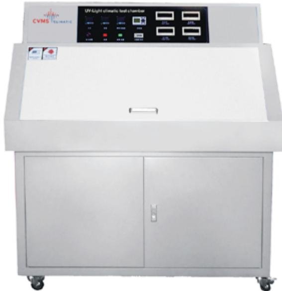
Предлагаем Вашему вниманию камеры солнечного излучения CVMS °Climatic. Испытательные камеры солнечного излучения предназначены для проверки стойкости изделий, внешнего вида и рабочих параметров к воздействию солнечного излучения и температуры, а также для проведения испытаний в условиях имитирования нормальных климатических условиях.
