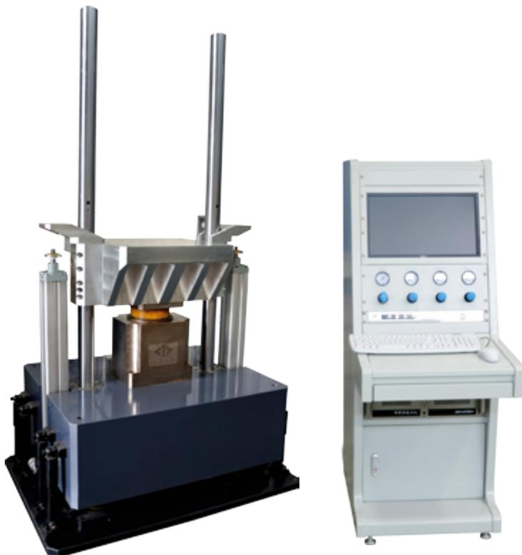
Пневматические ударные стенды Dongling серии SY-11 - это оборудование для воспроизведения одиночных и многократных ударных нагрузок. Стенды характеризуются простым управлением, удобным обслуживанием и высокой степенью автоматизации процесса испытаний, они обеспечивают проведение испытаний с формированием следующих импульсов:
