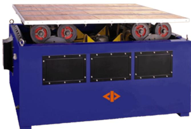
Стенды имитации транспортирования Dongling серии SY-50 – представляют собой оборудование для испытаний изделий на прочность и виброустойчивость при транспортировании. Также они предназначены для лабораторной оценки разрушения тары или материалов при конкретных условиях эксплуатации, например, при погрузке, разгрузке, и дальнейшей транспортировке.
